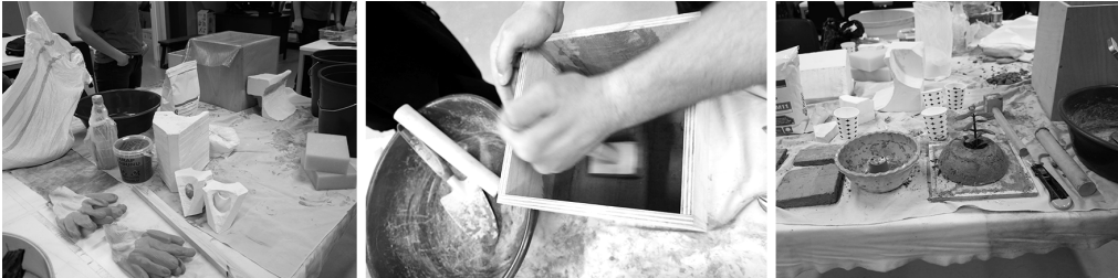
Şekil 7. “Komün-Aksiyon duvarı” prototipi ilk deneyler, toprak ve 3B baskı kalıplarla çalışma
